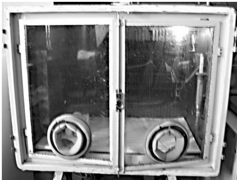
Рис. 4. Криостат для выделения интактных митохондрий и белков
