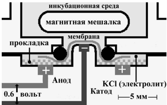
Рис. 8. Схема устройства электрода полярографической ячейки
